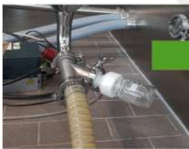
Fig 4. Foto Versuchsaufbau mit gewinkeltem Probenahmeauslass angeschlossen an pneumatische Förderung
